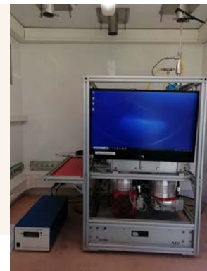
L'ACSM installé au Centre Hospitalier spécialisé du Rouvray à Sotteville-lès-Rouen mesure la matière organique et plusieurs composés inorganiques contenus dans les particules
