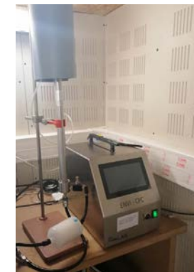
Le CPC installé au Havre en ville haute compte les particules ultra-fines ( <0,1\mu\text{m} ).
